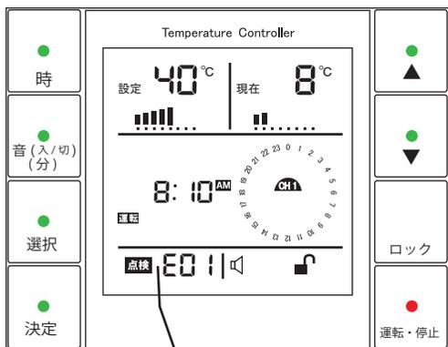
点検が、点滅して隣にエラー表示アラームは鳴り続けます。運転スイッチをタッチすると止まります
